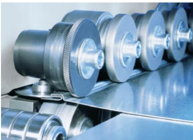
комплект роликов для изготовления фальца, тип "Pittsburg" (питтсбургский фальц) Pittsburgh dikişleri için silindir setleri
