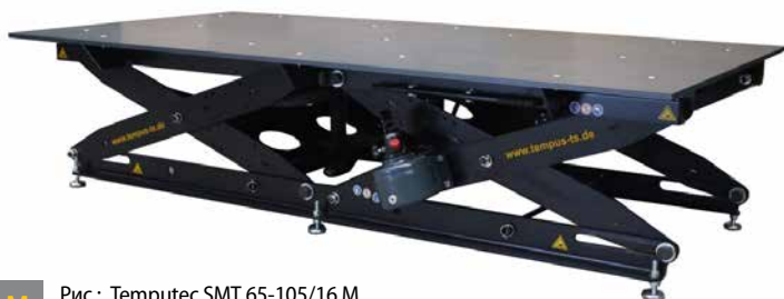
M Рис.: Tempotec SMT 65-105/16 M настольный размер 2,480 x 1,230 мм
