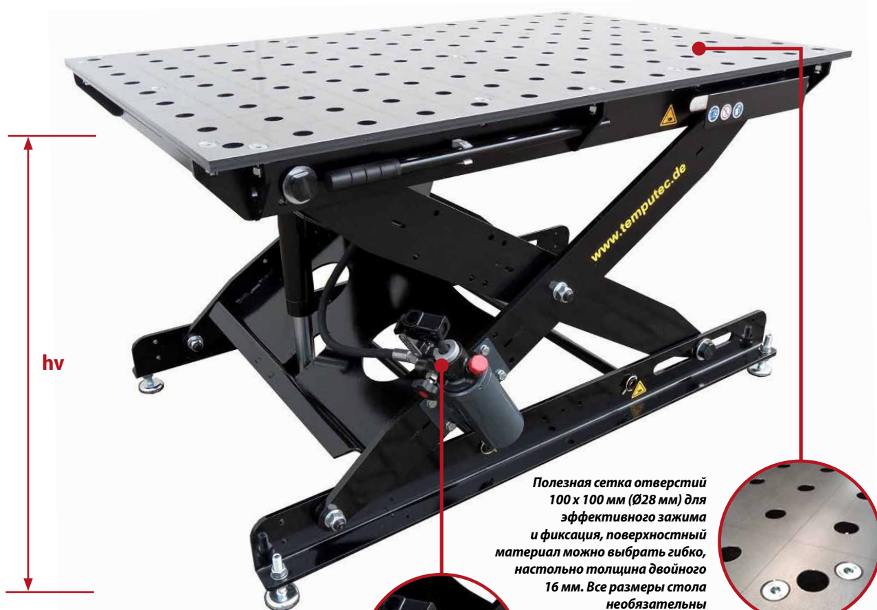
S Рис.: Temputec SST 65-105/16 S с гидравлической регулировкой высоты от 650 до 1,050 мм, настольный размер 1,400 x 900 мм, стандартный цвет черный
